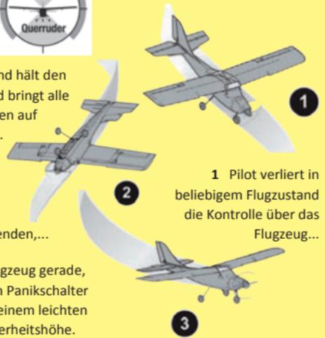
**WICHTIG:** Das Flugzeug steigt auf Sicherheitshöhe selbst wenn die Steuerknüppel gehalten werden. Selbst mit gezogenem Panikschalter wird ein kleiner Teil der Steuerbefehle noch genutzt.
