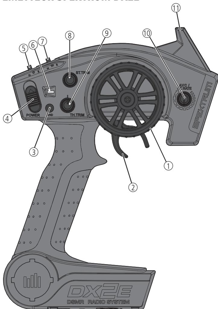
1. **Volant de direction** Commande la direction (gauche/droite) du modèle
