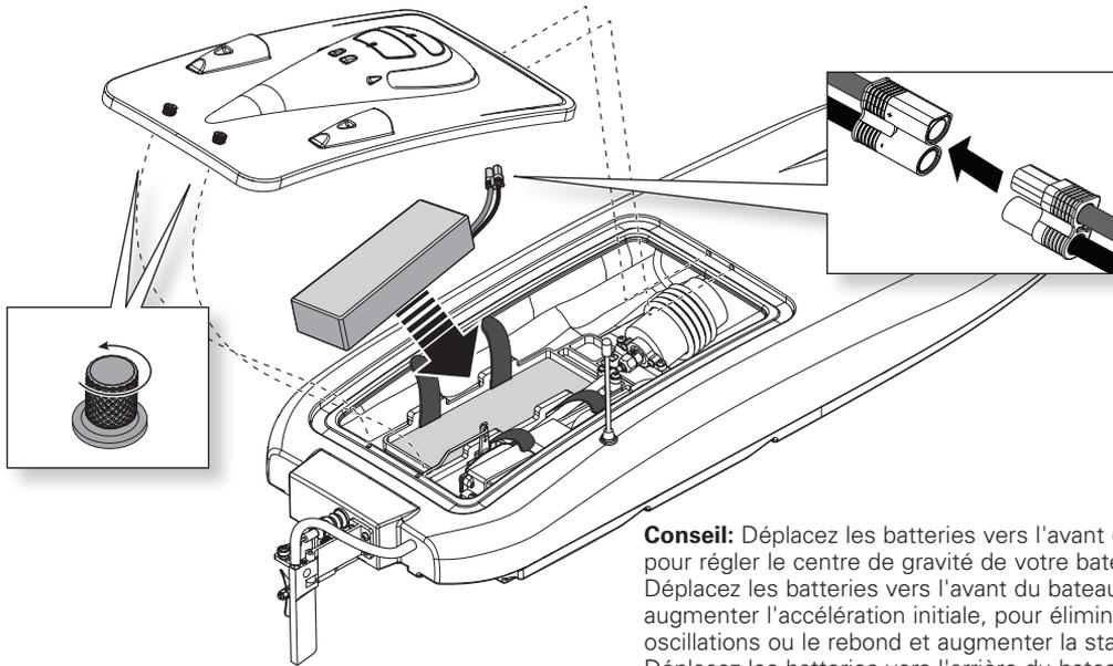
**Conseil:** Déplacez les batteries vers l'avant ou l'arrière pour régler le centre de gravité de votre bateau. Déplacez les batteries vers l'avant du bateau pour augmenter l'accélération initiale, pour éliminer les oscillations ou le rebond et augmenter la stabilité. Déplacez les batteries vers l'arrière du bateau pour permettre à la proue de se relever hors de l'eau pour augmenter la vitesse.
