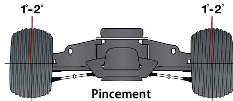
Pour augmenter la stabilité, ajoutez un ou deux degrés de pincement à chaque roue avant. Réglez l'alignement à l'aide de tendeurs
