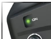
Si le témoin DEL clignote en rouge, les piles du transmetteur sont faibles, déchargées ou probablement installées incorrectement. Remplacez-les avec des piles toutes neuves ou récemment chargées. Le voyant d'alimentation n'indique pas le niveau de charge du bloc piles installé dans le modèle. Référez-vous à la section de Dépannage à la page 13 pour plus de renseignements sur les codes du témoin DEL du transmetteur.
