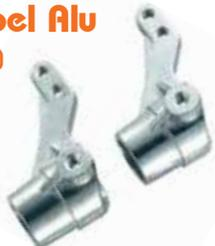
Lenkhebel / Achsschenkel Aluminium für alle 1:8 Top Line Modelle.
