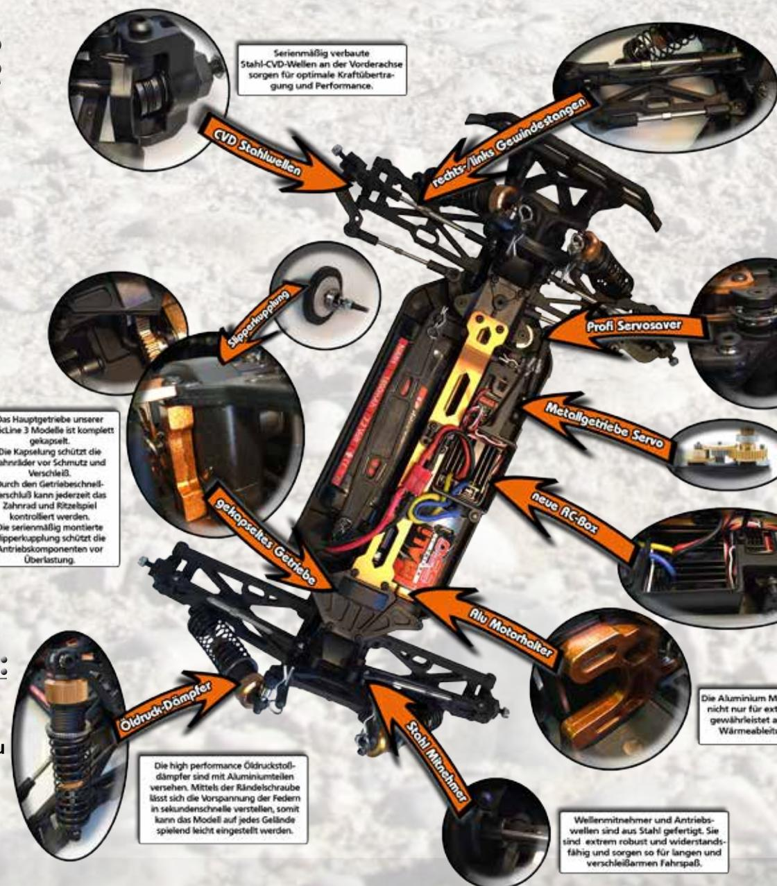
Serienmäßig verbaute Stahl-CVD-Wellen an der Vorderachse sorgen für optimale Kraftübertragung und Performance.
