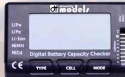
LCD Display | 3 Tasten bis 7 Zellen DIGITAL BATTERY CAPACITY CHECKER Minimal und Maximalanzeige Wertebereich pro Zelle (0-99%) Zellendifferenz (Zellenvergleich) Min / Max Typen: + Lipo (bis 7 Zellen) + Life (bis 7 Zellen) + Li-Ion (bis 7 Zellen) + NiCd + NiMH
